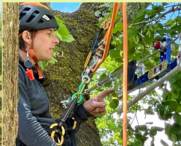
Suivie de la tension d'un système de haubanage.
